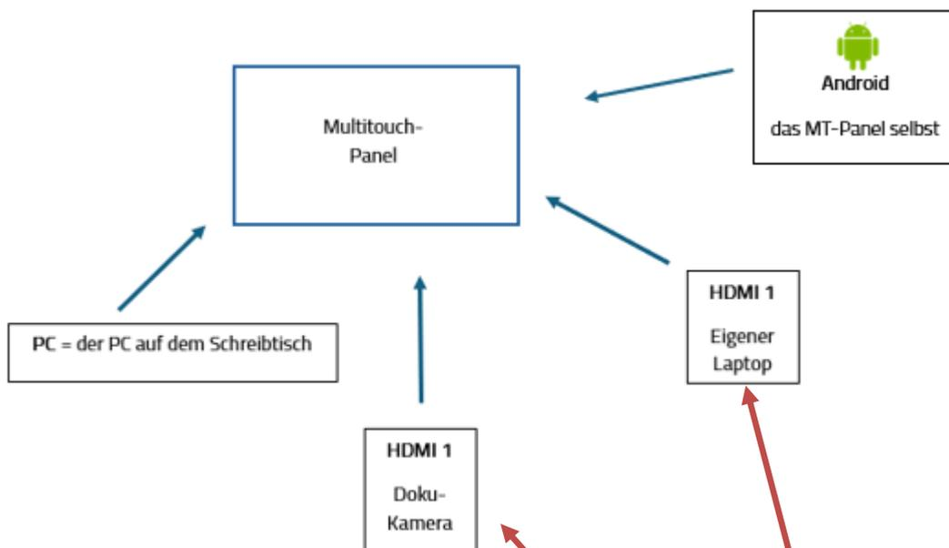
Da die Quelle HDMI1 sowohl den Laptop als auch die Lochkamera auf das MT-Panel überträgt, muss man an dem HDMI 2.0 Switch von Hand oder mit der Fernbedienung auf
